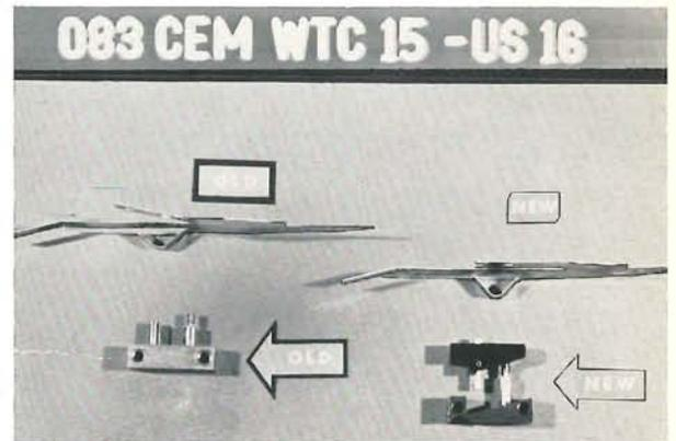
Oftmals sind verschmutzte KONTAKTE AN DRAHTRELAIS die Ursache für intermittierend auftretende Sortierfehler. Diese Fehler lassen sich schnell ermitteln und beheben, wenn grundsätzlich alle Relais gereinigt werden, statt nach dem verschmutzten einzelnen Kontakt zu suchen. Die Kontakte an den Drahtrelais lassen sich einfach mit einer Relais-Kontaktfeile reinigen. Bei der Gelegenheit können dann auch verbogene und verbrannte Kontakte und Kontaktdrähte erneuert werden.
